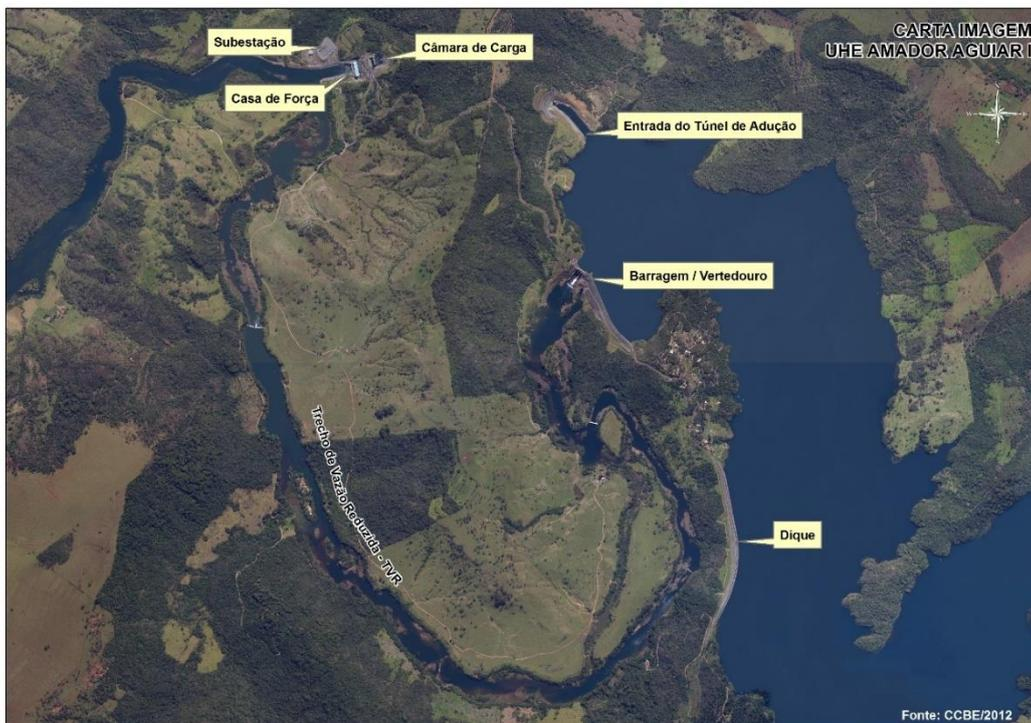
Figura 01– Arranjo Geral da UHE Amador Aguiar I
